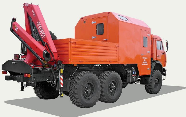
Агрегат предназначен для технического обслуживания и ремонта станков-качалок на нефтяных промыслах. Обеспечивает выполнение следующих видов работ:
