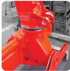
Литое основание, литые части колонны (нижняя и верхняя) равномерно распределяют рабочие нагрузки и позволяют значительно увеличить ресурс крана.
