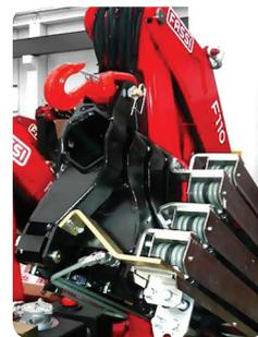
Система управления кранов-манипуляторов Fassi разделена на две части: на одном распределителе — управление опорами, на другом — стрелой. Таким образом, все краны Fassi защищены от ошибок оператора и случайного вытягивания опоры в момент, когда на стреле находится груз.
