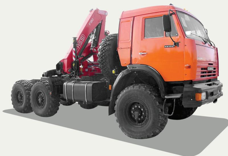
Агрегат предназначен для перевозки грузов на полуприцепе с самопогрузкой и саморагрузкой с помощью крана-манипулятора Fassi, установленного за кабиной автомобиля.
