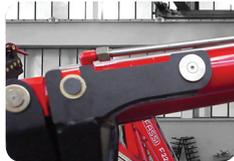
Трёхточечное крепление гидроцилиндров телескопа уменьшает их колебания и благоприятно сказывается на управляемости автомобиля.
