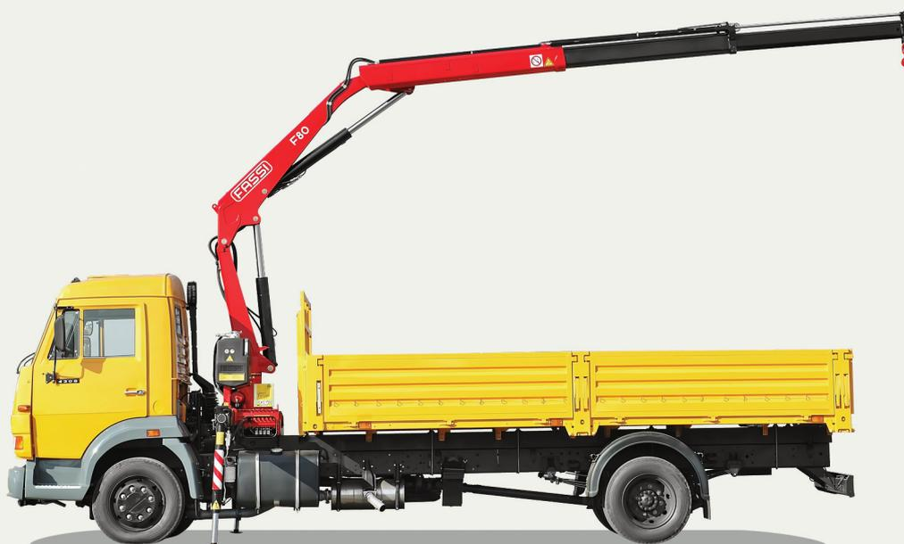
Автомобиль оснащён крано-манипуляторной установкой Fassi, предназначенной для самопогрузки и разгрузки бортовой платформы автомобиля, а также для выполнения монтажных работ на рассредоточенных объектах. Возможна установка других моделей кранов-манипуляторов Fassi на данное шасси за кабиной (от серии «Микро» до F 110) или на задний свес автомобиля.
