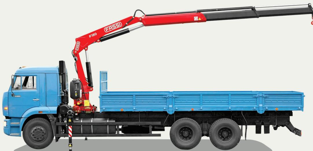
Автомобиль оснащён крано-манипуляторной установкой Fassi, предназначенной для самопогрузки и разгрузки бортовой платформы, а также для выполнения монтажных работ на рассредоточенных объектах. Возможна установка других моделей кранов-манипуляторов Fassi на данное шасси за кабиной (от серии «Микро» до F 245) или на задний свес автомобиля (до F 175).
