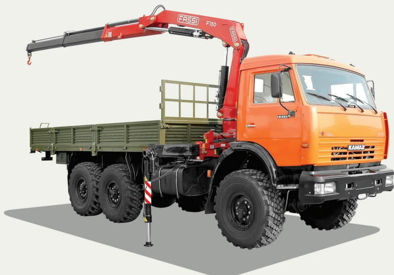
Автомобиль оснащён крано-манипуляторной установкой Fassi, предназначенной для самопогрузки и разгрузки бортовой платформы автомобиля, а также выполнения монтажных работ на рассредоточенных объектах. Возможна установка других моделей кранов-манипуляторов Fassi на данное шасси за кабиной (от серии «Микро» до F 155) или на задний свес автомобиля.
